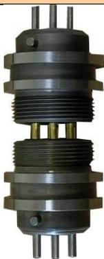
**ПРЕДНАЗНАЧЕН** для эксплуатации в составе электрических систем промыслово-геофизического и скважинного оборудования, работающего в условиях высокого давления и повышенной температуры окружающей среды. Соединитель состоит из двух герметичных блочных частей (вилки и розетки) с врубным способом сочленения.
