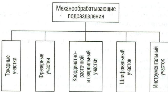
Рис. 6. Состав механообрабатывающих подразделений
