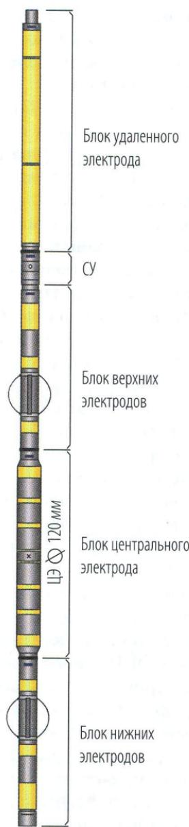
Рис. 5. Общий вид прибора автономного ЭКБР-А-90 со сменным блоком ЦЭ и установленными центраторами
