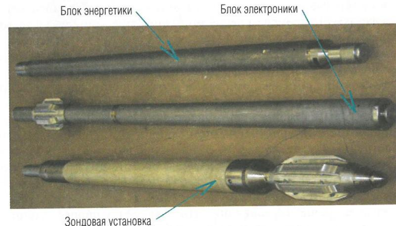
Рис. 1. Внешний вид прибора ЯМТК-150 (110)-120/100 кабельного исполнения
