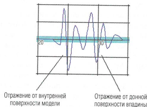
Рис. 2. Сигнал, отраженный от впадины диаметром 50 мм, канал 27, оценочная глубина впадины 3,5 мм
